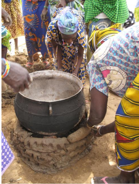
Foyers améliorés fabriqués par les utilisatrices selon une technique très simple
